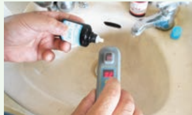
残留塩素測定検査
